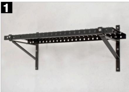
Wsporniki należy przy mocować bezpośrednio do ściany za pomocą stalowych kotew rozprężnych KŚ 8x80. Następnie przykręcić do nich ławę kominiarską. Ostatnim krokiem jest sprawdzenie poprawności wykonanego montażu, w szczególności należy sprawdzić stabilność wszystkich połączeń mechanicznych.
